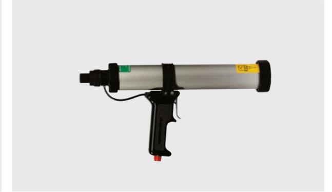
RM4 ist eine stabile Druckluftpresse mit präzisionsgeformtem Aluminiumrohr in bewährter, robuster Bauweise. Der Arbeitsdruck ist stufenlos an der Druckluftpresse regulierbar. Der ergonomisch gestaltete Pistolengriff ermöglicht bequeme Handhabung. Der Kolben wird von einer Sicherheitschnur gehalten. Für 400 ml-Folienbeutel. Betriebsdruck 6,8 bar.
