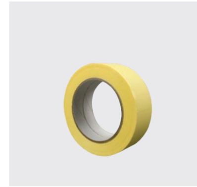
1310 Flachkreppband ist ein sehr dünnes und doch reißfestes Abdeck-Klebeband. Mit einem hitzestabilen Acrylatkleber beschichtet, um ein rückstandsfreies Wiederabziehen von Untergründen auch nach mehreren Wochen zu gewährleisten. Empfohlen zum Abkleben beim Verfüllen von Fugen bzw. zur Abdeckung bei Lackier- und Malerarbeiten im Innen- und Außenbereich.
