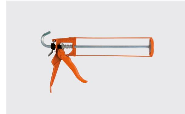
RSE ist eine handliche Skelett-Pressen mit geringem Gewicht und eingebauter Nachlaufbremse. Für Materialien mit geringer Viskosität. Für 310 ml-Kartuschen. Übersetzung 7:1.
