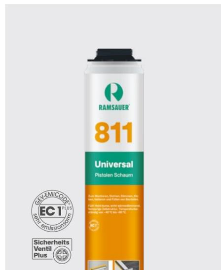
811 Universal Pistolen Schaum haftet hervorragend auf nahezu allen Untergründen wie Beton, Mauerwerk, Zement, Holz, Spanplatten, Gipskarton, Gasbeton, Putz und vielen Kunststoffen. Das Produkt ist ideal zum sauberen und kontrollierten Hinterfüllen und zum wärmedämmenden Abdichten von Fugen und Hohlräumen von Fenstern, Rolladenkästen und Außentürzargen. Schaumfarbe gelb. Baustoffklasse E und F nach DIN EN 13501-1. Geprüft auf Fugenschalldämmung vom ift Rosenheim.
