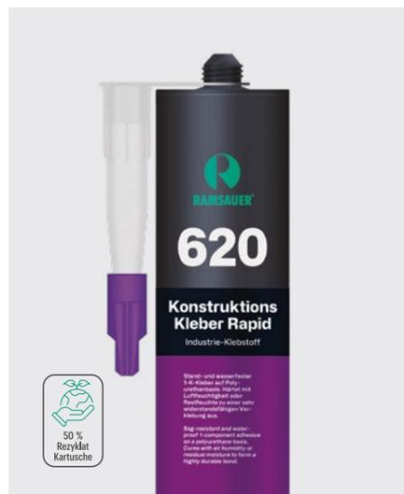
620 Konstruktions Kleber Rapid ermöglicht Montageverklebungen verschiedenster Art. Der Kleber haftet sehr gut auf vorbehandelten Metallen sowie auf Duro- und Thermoplasten, Holzwerkstoffen und zementgebundenen Werkstoffen. Geeignet zur Verklebung von Eckverbindern beim Alu-Fenster- und Türenbau. 620 Konstruktions Kleber Rapid kann ebenfalls für die Brettfugenverklebung von Kassetten im Holz-, Fenster- und Haustürenbereich eingesetzt werden. Optimal auch mit Flächendüse 80 mm verarbeitbar.
