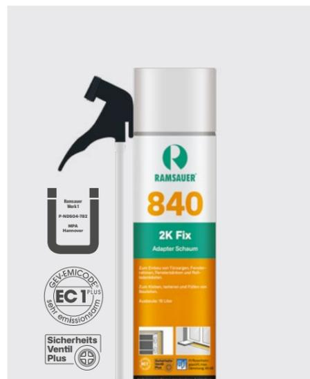
840 2K Fix Schaum zeichnet sich durch hohe Klebfestigkeit und gleichmäßige Schaumstruktur aus. Die Spreizeit liegt bei 30 Minuten. Nach ca. 10 Minuten ist er schneidfähig (Strang 20 mm) und nach ca. 180 Minuten voll belastbar. Ideal zum Verschäumen von Türzargen und Fensterelementen. Geeignet zur Verwendung als Wannensetzschaum. Schaumfarbe grün.
