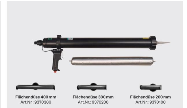
RM18 ist eine spezielle Druckluftpresse für zeitsparendes Auftragen von Flächenkleber in Verbindung mit 200/300/400 mm-Flächendüsen. Die Kleberaustrittsmenge wird am Druckregler entsprechend der Verarbeitungsgeschwindigkeit angepasst. Dies ermöglicht ein sauberes, gleichmäßiges Auftragen in definierter Schichtstärke. Für 1800 ml-Folienbeutel. Betriebsdruck 6,8 bar.
