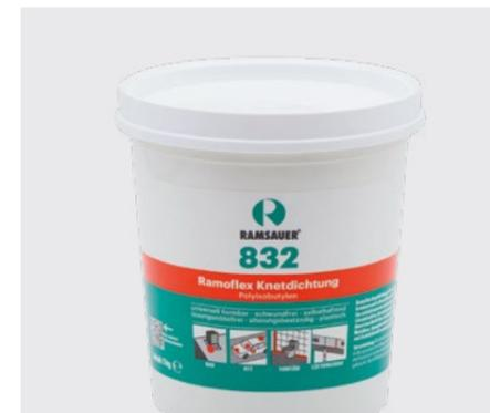
832 Ramoflex Knetdichtung ist eine selbsthaftende, formbare und schwindfreie Knet-Dichtmasse. Sie enthält keine korrodierenden Bestandteile, ist lösemittelfrei, dauerplastisch und alterungsbeständig. Sie eignet sich zum Abdichten von Rohrdurchführungen und Rissen im Alu-, Metall- und Fahrzeugbau.
