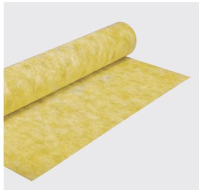
Beidseitig vliesbeschichtete, hoch reißfeste sowie wasserdampfbremsende Abdichtungsbahn mit guter Verbundhaftung zu zementären Dünnbettmörteln und flüssigen Verbundabdichtungen, wie Polymerdispersionen, flexiblen Dichtungsschlämmen und Reaktionsharzen. Die Bahn lässt sich leicht verarbeiten und ist besonders als schnelle Abdichtungsmaßnahme geeignet.
