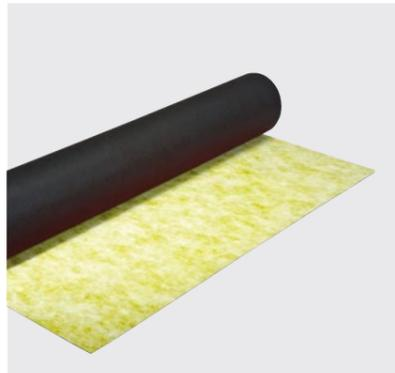
Beidseitig vliesbeschichtete, hoch reißfeste sowie wasserdampfbremsende Dichtbahn mit guter Verbundhaftung zu zementären Dünnbettmörteln und flüssigen Verbundabdichtungen, wie Polymerdispersionen, flexiblen Dichtungsschlämmen und Reaktionsharzen. Die Bahn lässt sich leicht verarbeiten und ist besonders als schnelle Abdichtungs- und Entkopplungsmaßnahme geeignet.
