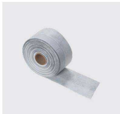
Elastisches Dichtband auf NBR-Kautschuk-Basis mit beidseitiger Vliesbeschichtung und einseitig starkklebendem Butylkautschukklebestreifen. Zur universellen Abdichtung von Dusch- und Badewannen aus emailliertem Stahl bzw. Kunststoff.
