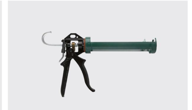
RH7 ist eine handliche Halbschalen-Pressen mit schaltbarer Nachlaufbremse in bewährter, robuster Bauweise. Der stabil geschweißte Stahlrahmen mit Epoxidharzbeschichtung und verzinkten, korrosionsbeständigen Gleitteilen ermöglicht höchste Leistung und eine lange Lebensdauer. Für Materialien mit mittlerer und hoher Viskosität. Für 310 ml-Kartuschen. Übersetzung 12:1
