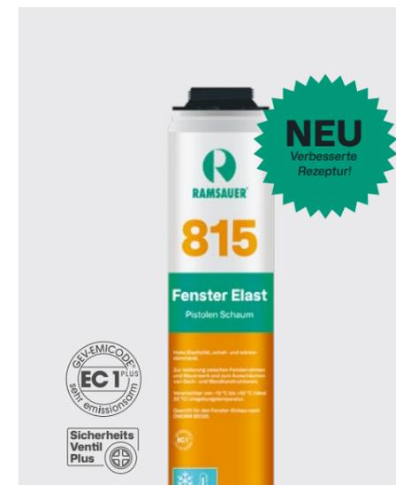
815 Fenster Elast Pistolen Schaum eignet sich hervorragend zum Ausschäumen von Dach- und Wandkonstruktionen und zur Montage von Fenstern. Durch seine Elastizität verfügt er über optimales Dehn- und Stauchvermögen und weist außerdem ausgezeichnete Wärme- und Schalldämmwerte auf. Schaumfarbe grau. Als Ganzjahresschaum einsetzbar (-10 bis +30 °C). Baustoffklasse E nach DIN EN 13501-1. Geprüft auf Fugenschalldämmung vom ift Rosenheim. Geprüft nach ÖNORM B 5320.
