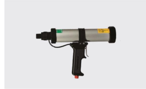
RM3 ist eine leichte, kompakte Druckluftpresse mit präzisionsgeformtem Aluminiumrohr in bewährter, robuster Bauweise. Die vielseitig einsetzbare Druckluftpresse bringt mittels Direktmechanismus die Druckluft unmittelbar an den Kartuschenkolben. Der ergonomisch gestaltete Pistolengriff ermöglicht bequeme Handhabung. Stufenlos regulierbarer Arbeitsdruck an der Dichtstoffpistole. Für 310 ml-Kartuschen.
